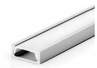
LED PÁSEK (1,8m) - LED pásek zafrézovaný do spodní strany skříňky - nerezový profil 15*6 mm - opálový difuzor, barva světlá bílá 4300 - 5300K
